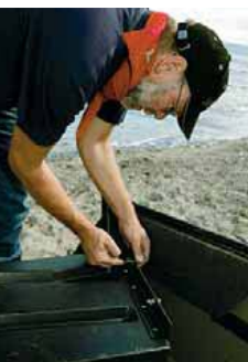
VINGE-LETE: Det blir mange vingemuttere å dra til på Porta-Bote. Hurtiglåser hadde forenkla monteringer betydelig.
